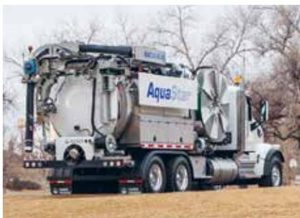
AquaStar in Kalifornien: Das patentierte KAISER-Rückgewinnungssystem erspart 24'000'000 Liter Frischwasser pro Jahr und Fahrzeug.
